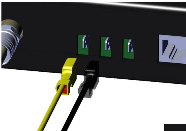
Per il negativo dell'alimentazione usare il connettore Centrale
