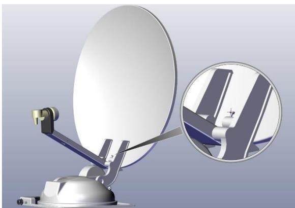
Con un cacciavite, regolare la vite indicata a fianco in modo che la distanza tra il bordo in alto della parabola e la fine del braccio sia pari a **67** cm per la parabola da 65cm e di **86** cm per quella da 80cm
